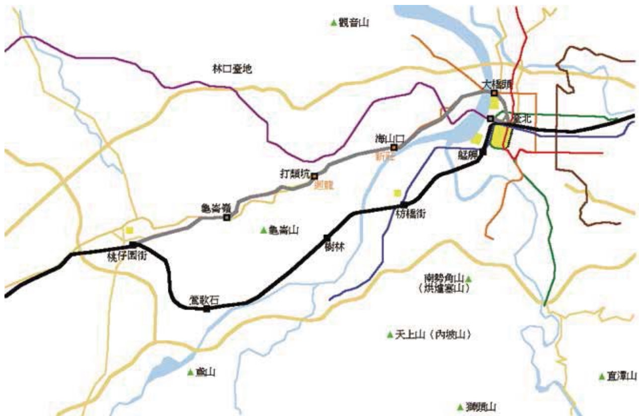
圖八 改線前（灰色）與改線後（黑色）的臺北—桃園鐵道路線圖，本圖及以下各圖北方朝上。本圖也標出河流、捷運（彩色線）與公路（淺黃色線，高速公路為粗線、省道為細線）的位置進行比較。黃色區域為二十世紀初的市區範圍，臺北城四面的城牆被拆除後成為道路，之後鐵道與捷運隧道又沿著北面、西面與南面城牆的位置建設，東城牆則為現在的中山南路（黑色虛線）。清朝的劉銘傳鐵道大橋頭—打類坑（塔寮坑）區間與後來捷運新莊線（橘線）新北市段的位置相當類似，只有二重疏洪道地下段不同。大橋頭、海山口與打類坑站則分別成為捷運大橋頭、新莊與迴龍站。
