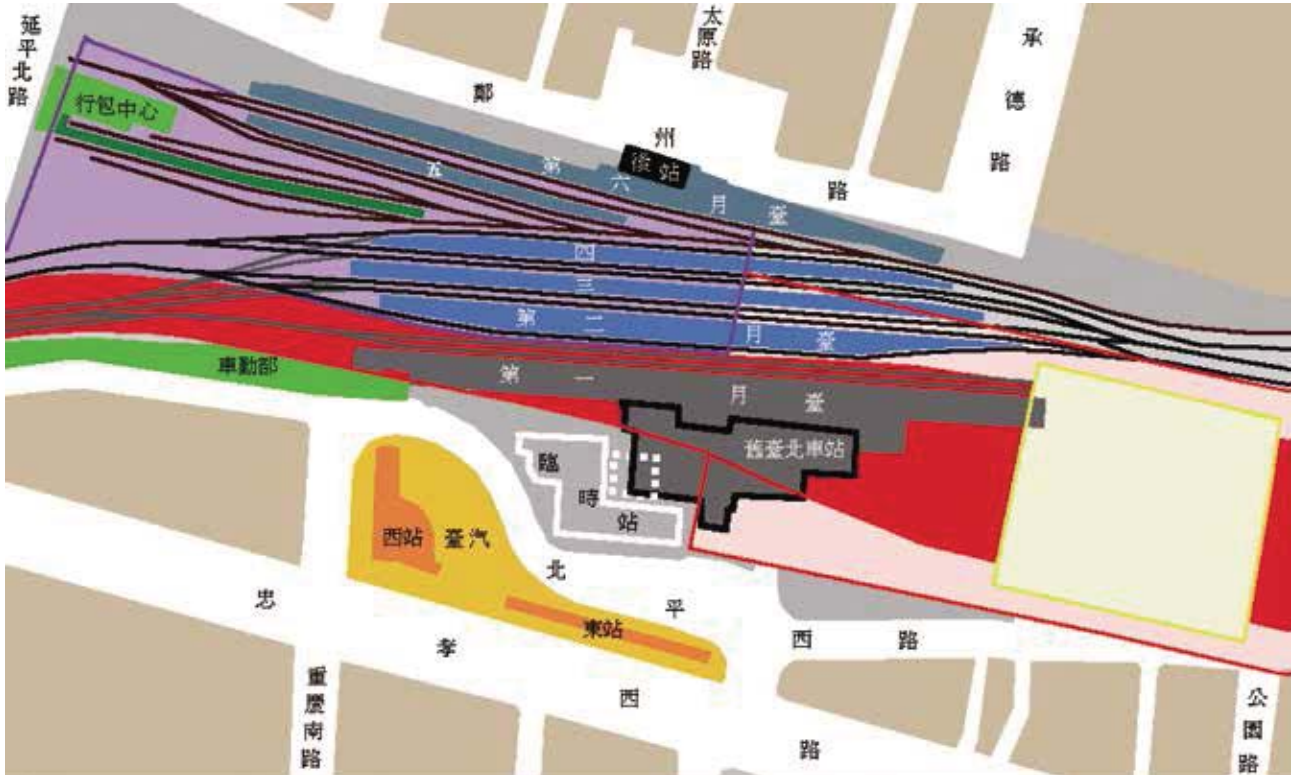
圖十一 第三代臺北車站（圖中標示為「舊臺北車站」）、臨時站、第四代臺北車站（淺黃色長方型區域）與後來的機場捷運臺北車站（紫色區域）的相對位置示意圖。為了配合舊臺北車站拆除，臨時站分為第一期（白線實線區域）與第二期（虛線區域），原始圖片中還標出跨線天橋的位置，本圖予以省略。在西側地下隧道（紅色區域）施工前，在原來軌道的北邊施作臨時軌道以維持臺鐵營運。黃色區域為臺汽客運（原來的公路局、後來改組為國光客運）臺北站的使用範圍，站房分為西站及東站，東站原來在更東邊，為了配合臺北車站改建而被移到圖中的位置。
